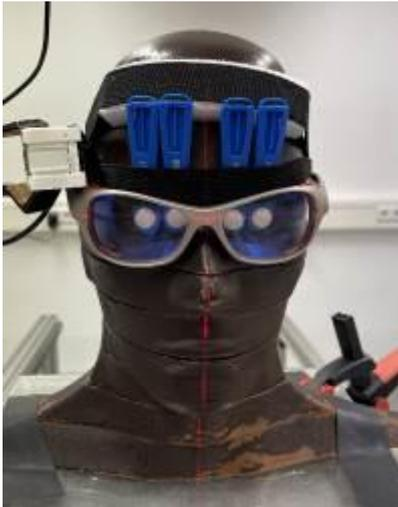
Abb. 1: Alderson-Phantom mit Augenlinsendosimeter mit Bleiglasplättchen (links) und TLDs hinter einer Strahlenschutzbrille
